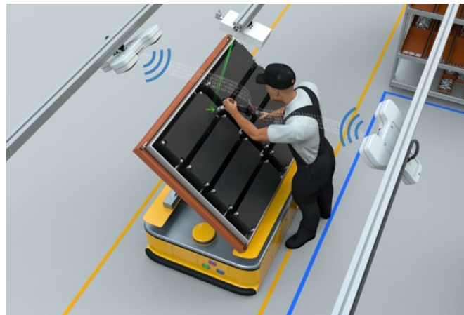
Connexion à vis d'un module de batterie à un angle spécifique.
