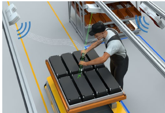
L'AGV s'arrête à différentes positions car l'émetteur d'outil Sarissa référence un système de coordonnées en mouvement.
