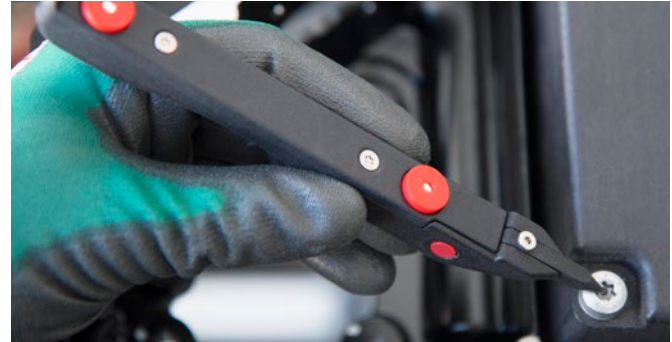
Les positions sont soit apprises directement avec l'outil, soit avec le pointeur de position.
